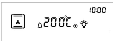
После активации будильника вы можете отключить функцию будильника, установив будильник на «0:00». Когда время будильника истечет, раздастся звуковой сигнал и замигает логотип будильника.
